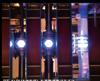
DT-ALPHAで生成した高熱流束プラズマ
